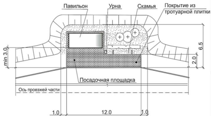
Рисунок 2 – Вариант схемы автобусной остановки
