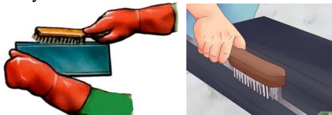
Рисунок 4. Очистка поверхности пластины от шлаковой корки щеткой по металлу
