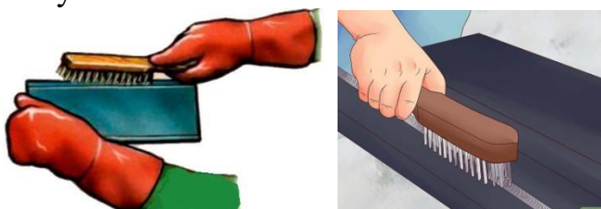
Рисунок 4. Очистка поверхности пластины от шлаковой корки щёткой по металлу
